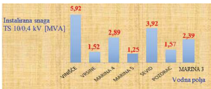
Slika 2 - Instalirana snaga TS 10/0,4 kV na području općine Marina po vodnim poljima 10 kV iz TS 35/10 kV Marina
